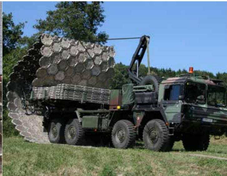
Das Faltstraßenmattensystem ist unverzichtbar bei der Sicherstellung der Bewegung.
