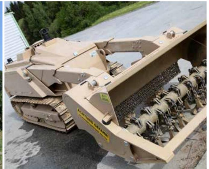
Minenräumsysteme, hier das System MV-4, gehören zur Standardausrüstung der Pioniere.
